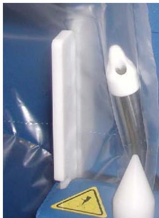
6. Trek folie door machine tot beginpunt van transportrollen. Toets FEED-↓ en trek folie verder door machine heen.
