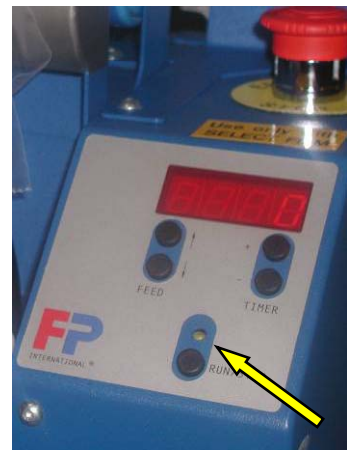
5. Wacht totdat lampje bij START/STOP toets GROEN is (GEEL licht geeft aan dat machine nog opwarmt).
