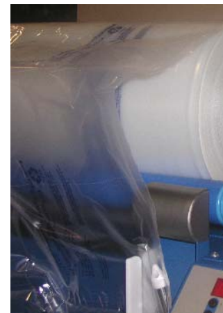
7. Zorg ervoor dat er 10cm speling van de folie is.
