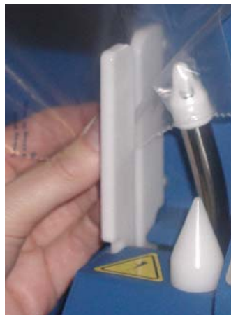
4. Open blaaskanaal in folie aan rechthoekig en plaats folie over inblaaspipje.
